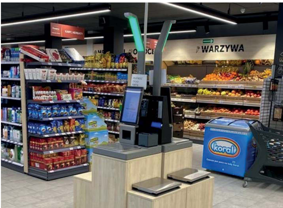
Světelná tyč vybavená kamerou je zahnutá tak, aby kamera viděla na vážící prostor váhoskenneru. Celý systém řídí aplikace, která dokáže rozpoznat vážené produkty. Díky tomu zákazník nemůže skenovaný nebo vážený produkt zaměnit.
