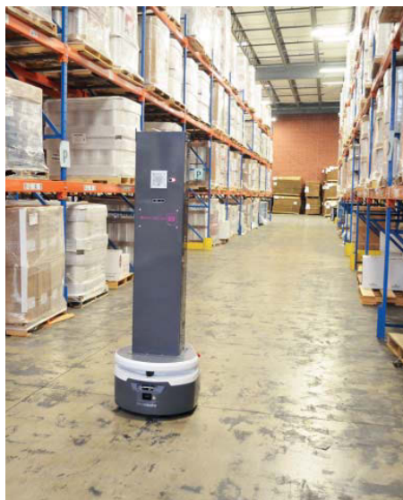
SmartGuard UV dezinfikuje okolní prostředí pomocí UV záření.
