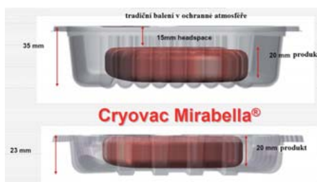
Obr. č. 2: Znázornění nároku na prostor při balení masa v ochranné atmosféře a způsobu Cryovac Mirabella (upraveno podle Métais, 2011)
